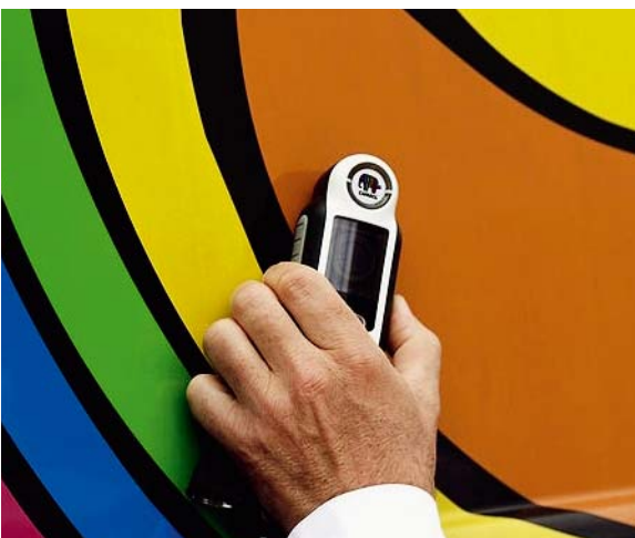
Der Buntstift 3D misst in Sekundenschnelle Farbtöne und nennt sie beim Namen.
