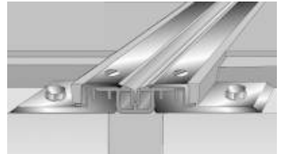
Bild 4: Fugenausbildung in Bodenflächen mit vorgefertigtem Fugenprofil. (1) vorgefertigtes Fugenprofil (2) Disboxid 438 EP-Spachtel oder Disboxid EP- Mörtel (3) Beschichtung Disboxid Parkhaus-System
