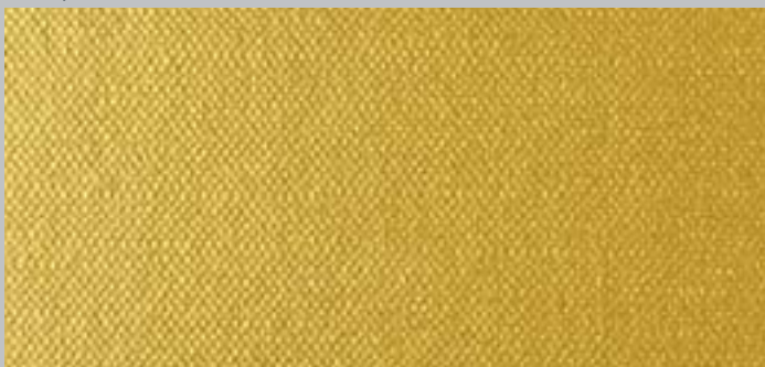
Gerollt: Jacquard Modern Web, 2x EffektGrund im Farbton „GoldGrund“, 2x CapaGold senkrecht nachgerollt
