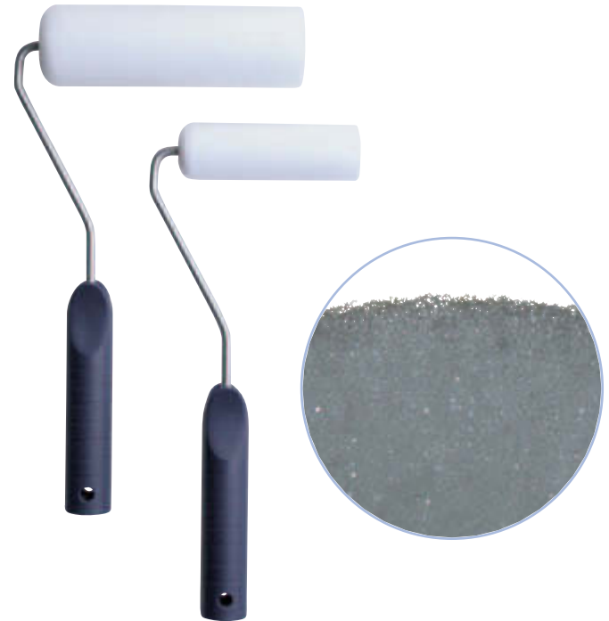
Schaumstoffrollen, bügelseitig abgerundet. Diese Rollen eignen sich zum gleichmäßigen Nachrollen des mit der Polyamidrolle aufgetragenen Lackes.
